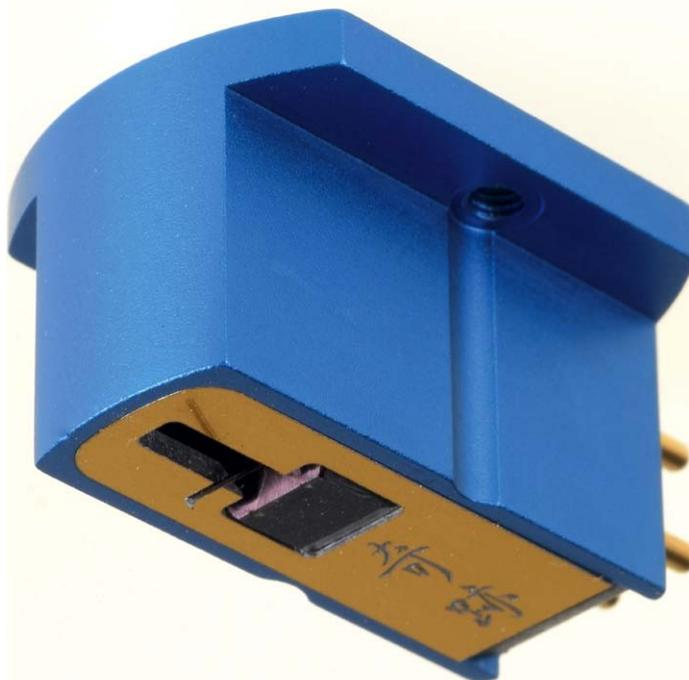
Der abgerundete Body des Abtasters ist in puncto Justage keine allzu gute Idee. Mit seinen 40 Ohm Innenwiderstand sollte der Kiseki zwischen 200 und 500 Ohm abgeschlossen werden. Die Nadelnachgiebigkeit des Blue ist mit 16 Mikrometer pro Millinewton spezifiziert.
