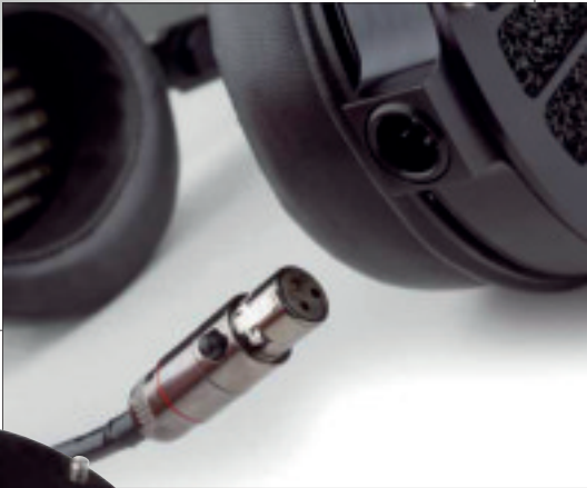
• Die Anschlusskabel des Kopfhörers kommen natürlich von JPS und sind austauschbar. Kleine, präzise Mini-XLR-Stecker sorgen für die Verbindung
