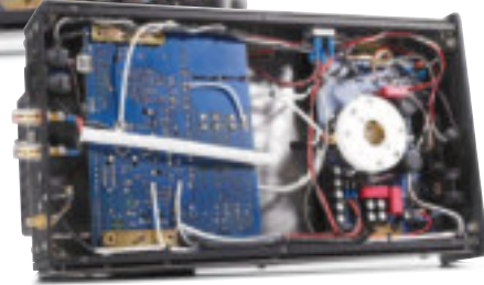
DER NAT-MONO MIT 211: Mit ebenfalls reich bestückter Versorger-Platine. Es gibt nur die Normal-Boxenklemmen, dafür besitzt der SE 1 die Feedback-Anpassung.
