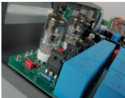
Die hybride Ausgangsstufe mit den beiden ECC-81-Röhren harmonisiert gut mit dem Klang des Ladder-DACs
