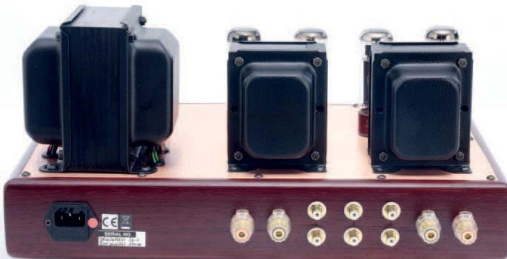
Drei Hochpegeleingänge und ein offenkundig salomonisch in die Mitte zwischen Acht- und Vier-Ohm-Lasten gelegter Ausgangsübertrager ohne Extra-Anzapfungen. Auf Wunsch fertigt Tektron auch spezielle Übertrager, so etwa für ausgeprägt hochohmige Lautsprecher.
