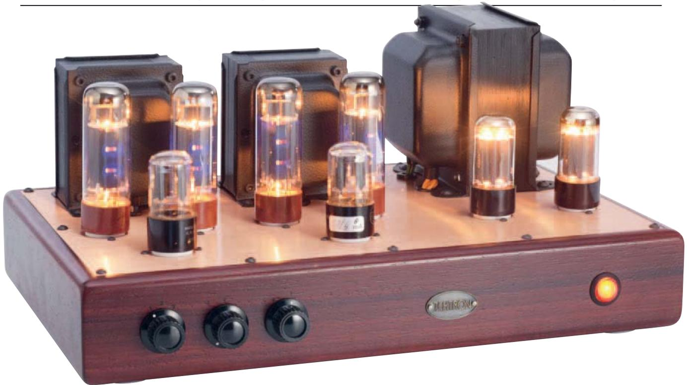
Wenn es jetzt sizilianisch und eher bodenständig altmodisch wird, müssen die Fans penibel bestückter Platinen und mit dem Lineal gezogener Drähte tapfer sein. Denn dieser Röhrenvollverstärker aus dem sizilianischen Catania huldigt jener nonchalanten Bauart, mit der sich praktisch die ganze frühe Unterhaltungselektronik durchgeschlagen hat. Und das hat funktioniert. Und im Falle von Omas Küchenradio sogar jahrzehntelang.
