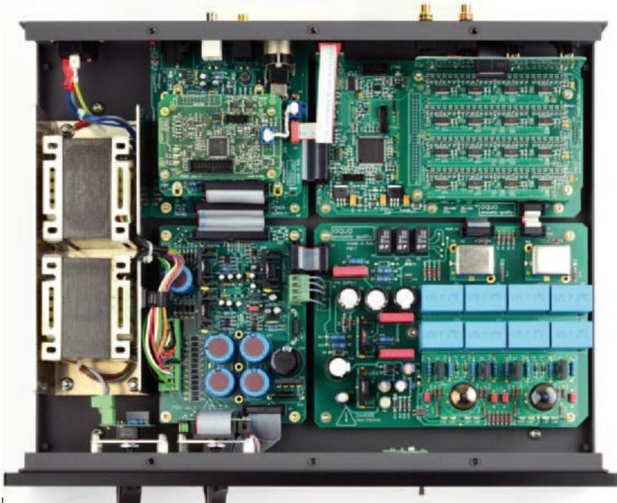
**MODULARER AUFBAU:** Jede Baugruppe im Inneren des La Scala sitzt auf einer eigenen Platine. Ganz links die magnetisch abgeschirmten Transformatoren, oben rechts erkennt man das Wandlerboard. Unten rechts die analogen Komponenten und die Röhren.
