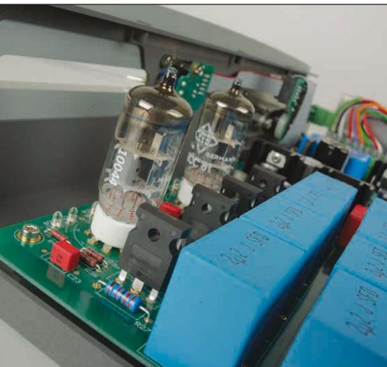
Die hybride Ausgangsstufe mit den beiden ECC-81-Röhren harmoniert gut mit dem Klang des Ladder-DACs
