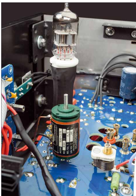
Dieses Trimpotenzimeter ist ein hoch belastbares und sehr edles Modell
