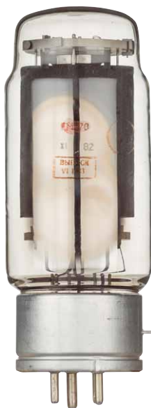
Die GM70: ein Prachtstück russischer Röhrenbaukunst: eine echte Triode mit 125 Watt Anodenverlustleistung
