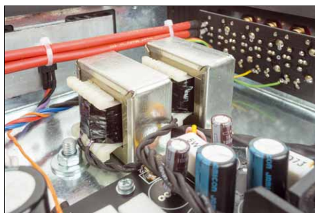
Statt einer RC-Filterung hat man sich an vielen Stellen für die aufwendigere (und teurere) LC-Filterung entschieden
