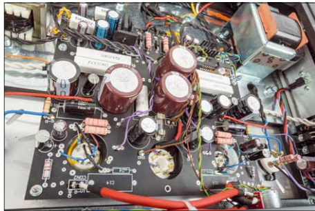
Im Inneren finden wir eine Mischung aus Platinen und freier Verdrahtung
