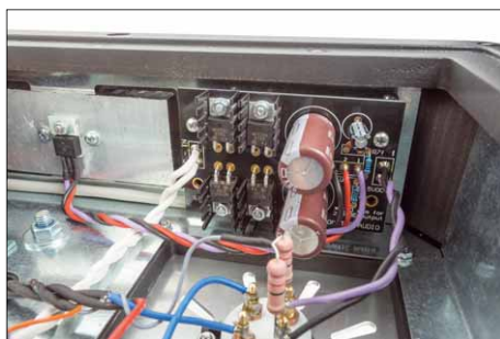
Die Kabelführung im Inneren ist sehr aufgeräumt. Alle Spannungen werden sauber gefiltert
