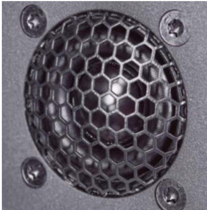
Der Hochtöner ist mit 19 mm besonders klein, um bis in die höchsten Höhen sauberes Rundstrahlen zu ermöglichen. Aufgehängt ist er an einer sehr großen und wulstigen Sicke, um bei Belastungen im Ausblendbereich problem- und klirrfrei mitgehen zu können.
