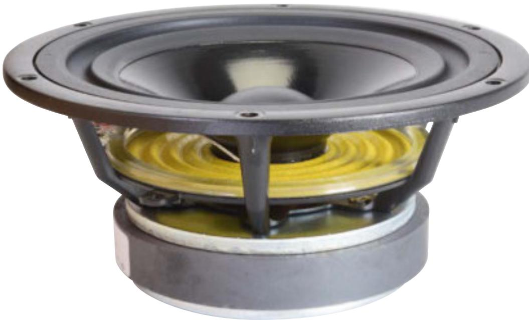
Der 6-Zöller sieht von vorn klassisch aus, dahinter steckt modernste Chassis-Technik: ein besonders filigraner Gusskorb, ein kräftiger Magnet, eine weite Zentrierspinne, die so hinterlüftet ist, dass sich keine Kompressionen um den Magnetspalt herum einschleichen können. Die Sicke ist nach hinten gewölbt.
