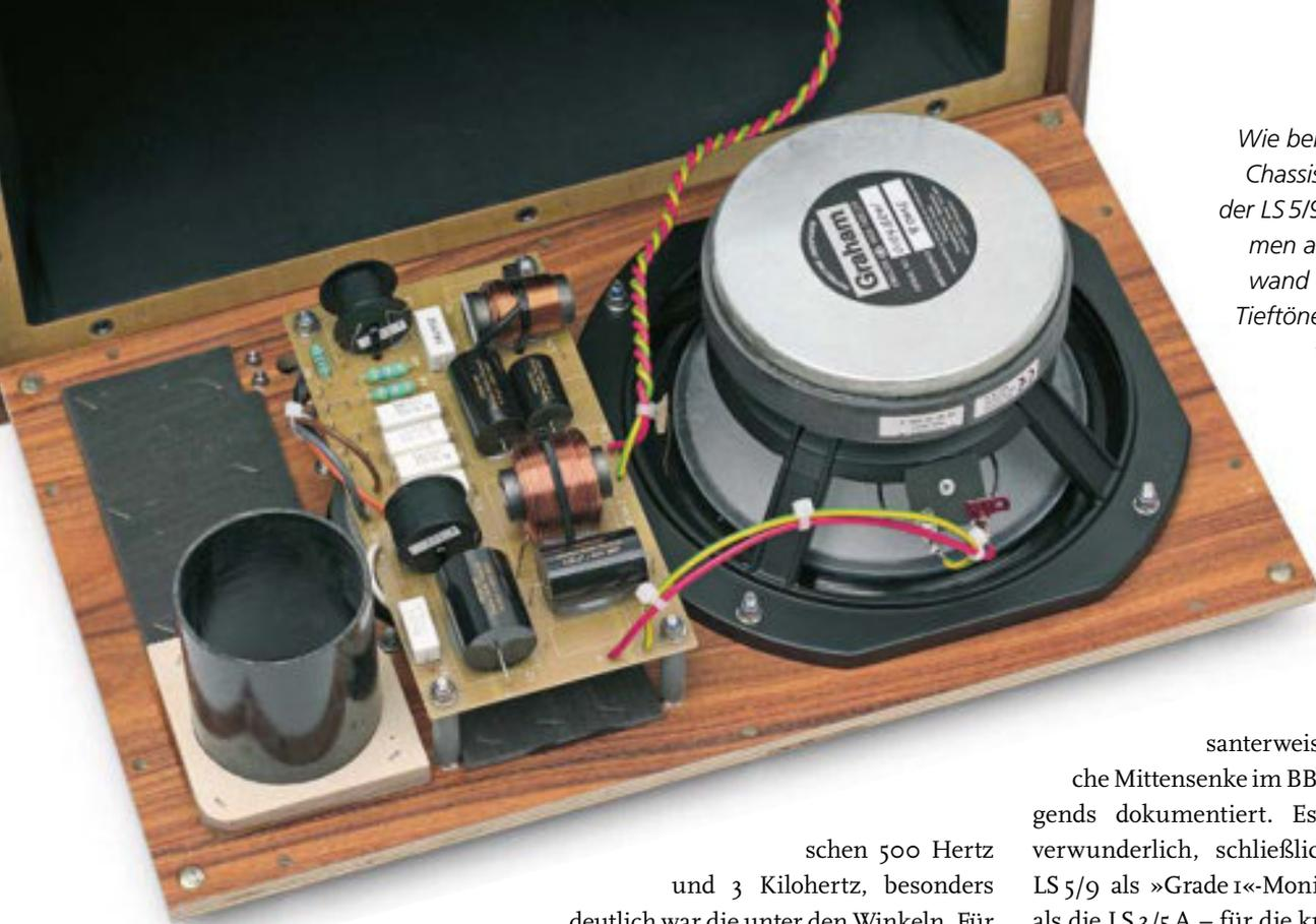
Wie bei der LS3/5A: Chassis und Weiche der LS 5/9 sind zusammen auf der Schallwand montiert, der Tieftöner ist von hinten befestigt.
