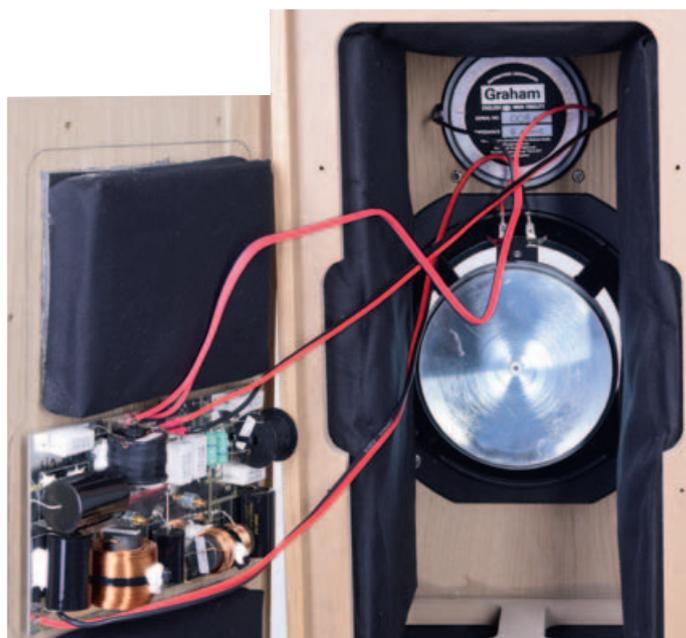
Der 3,4-cm-Hochtöner und der von einem großen Magneten angetriebene 20-cm-Tieftöner entsprechen der kompakten LS 5/9. Die aufwendige Frequenzweiche wurde im Bass leicht angepasst.
