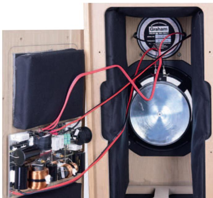
Der 3,4-cm-Hochtöner und der von einem großen Magneten angetriebene 20-cm-Tieftöner entsprechen der kompakten LS 5/9. Die aufwendige Frequenzweiche wurde im Bass leicht angepasst.
