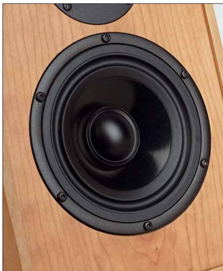
Das ist Standard bei BBC-Monitoren: Der Tiefmitteltöner arbeitet mit einer gutmütigen Polypropylen-Membran
