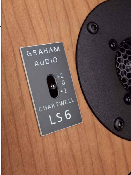
Der Hochtonbereich kann per Schalter zweistufig abgesenkt werden. Bei uns bestand keinerlei Notwendigkeit dazu
