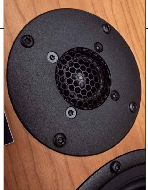
Die Membran der Hochtongkalotte durmisst nur 19 Millimeter, was dem Rundstrahlverhalten zugutekommt
