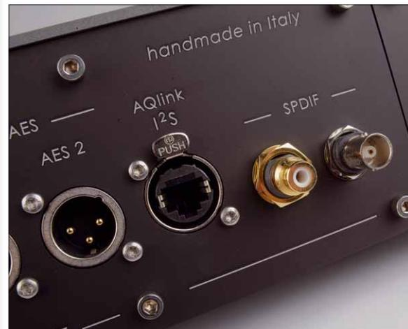
Mit AQ-Link und Dual-Wire AES/EBU lässt sich das Quellgerät gut mit hochwertigen Wandlern kombinieren
