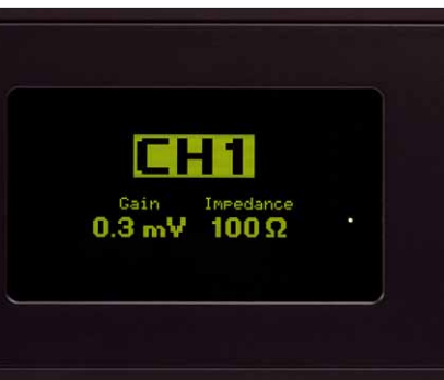
Die „Normalansicht“ des Displays. Es zeigt den gewählten Eingang, die Verstärkung und die Eingangsimpedanz
