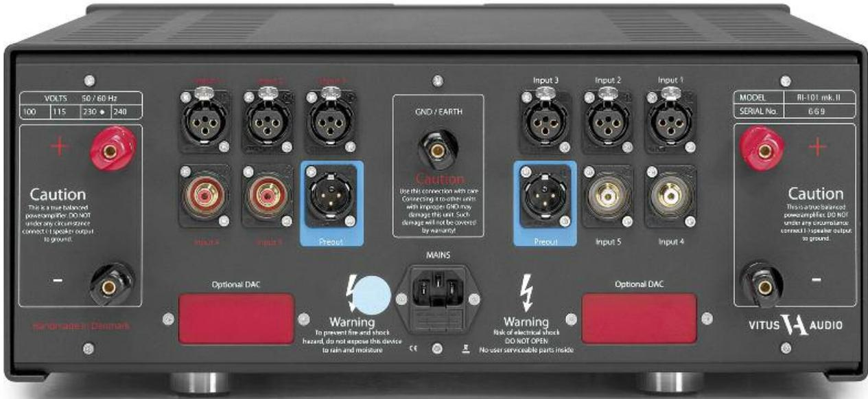
Die beiden roten Rechtecke auf der Geräterückseite sind die Schächte, in die optional ein DAC/Streamer eingelassen werden kann. Es gibt drei symmetrische Eingänge und zwei unsymmetrische
