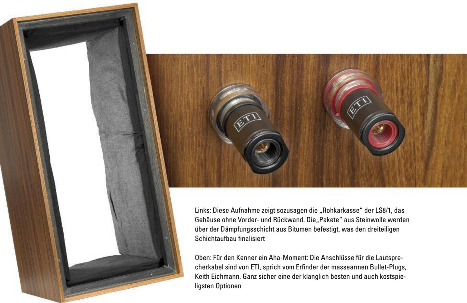
Links: Diese Aufnahme zeigt sozusagen die „Rohkarkasse“ der LS8/1, das Gehäuse ohne Vorder- und Rückwand. Die „Pakete“ aus Steinwolle werden über der Dämpfungsschicht aus Bitumen befestigt, was den dreiteiligen Schichtaufbau finalisiert
