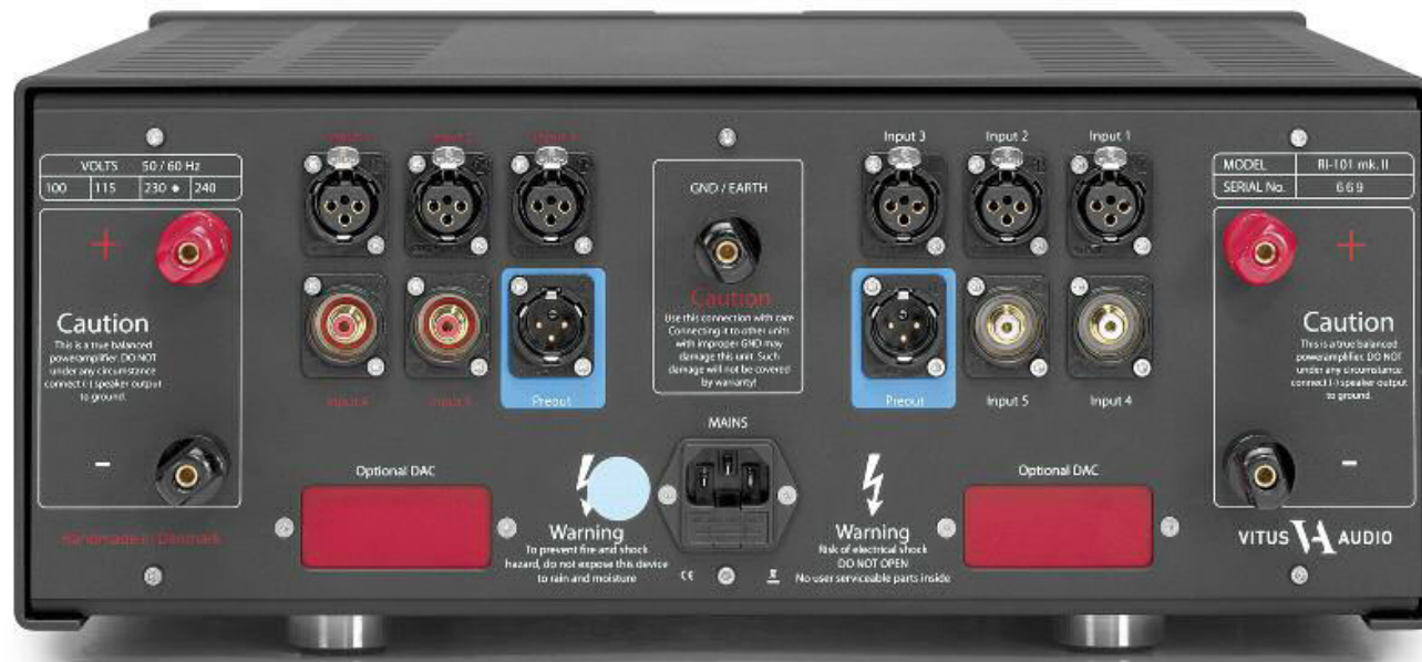
Die beiden roten Rechtecke auf der Geräterückseite sind die Schächte, in die optional ein DAC/Streamer eingelassen werden kann. Es gibt drei symmetrische Eingänge und zwei unsymmetrische
