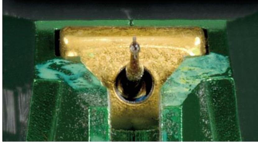
sagt Ledermann, „ist, dass sie ein natürlicher Tiefpass-Filter ist.“ Alles um die 30 oder 35 kHz wandelt sich um in Wärme und löst sich auf. Ledermann vergleicht es mit dem Stoßdämpfer im Auto, der eine Energieform in eine andere umwandelt. Kurzum: Eine Kaktusnadel verbindet das Beste aller Welten. Sie ist starr in dem Bereich, in dem sie starr sein muss. Sie hat hervorragende Dämpfungseigenschaften. Und: Sie ist äußerst robust.
