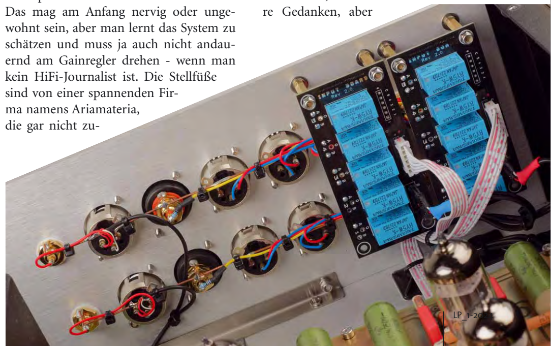
Feinster Aufbau mit penibel kurz gehaltener Verkabelung. Die Eingänge werden sauber per Relais geschaltet
