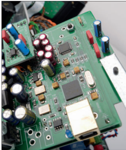
Das DAC-Board verarbeitet einzig USB und PCM-Signale, tut dies aber dafür umso konsequenter
