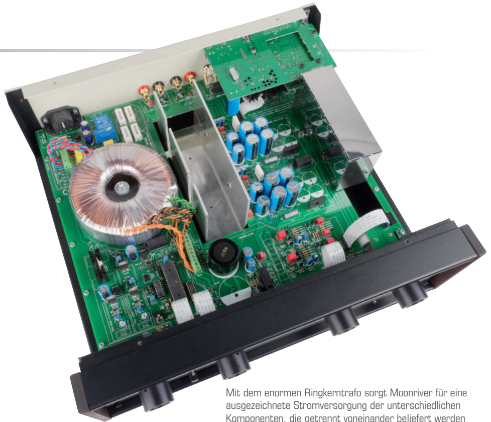
Das DAC-Board verarbeitet einzig USB und PCM-Signale, tut dies aber dafür umso konsequenter
