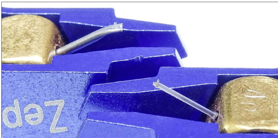
Bei identischen „Line Contact“-Diamanten unterscheiden sich die Nadelträger. Beim Zephyr MK III ist dieser ein Aluminiumröhrchen (l.), beim MIMC Star ein massives Stäbchen aus hartem Saphir.
