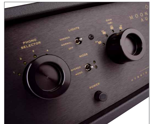
Front links. Hier sieht man vor allem den Eingangsschalter für die vier Eingänge und rechts den Gainregler: alles extrem angenehm in der Praxis
