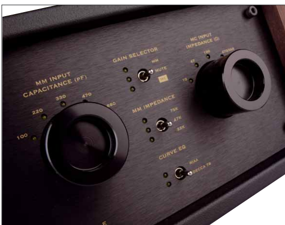
Hier sieht man das Bedienkonzept sehr schön: Regler für Kapazität (MM) und Impedanzen (MC) sowie diverse Kippschalter
