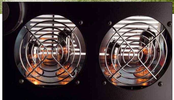
• Damit die Röhren Kühlung bekommen, sind auch im Boden unter den Röhren Lüftungsöffnungen. Sieht ziemlich schick aus
